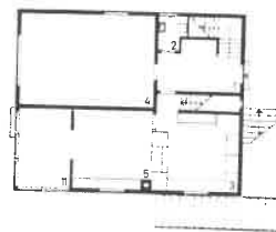
▲ Erdgeschoss: 1 Flur, 2 Bad + WC, 3 Küche, 4 Wohnraum, 5 Esszimmer, 11 Terrasse / Ground floor: 1 Hall, 2 Bath/WC, 3 Kitchen, 4 Living room, 5 Dining room, 11 Terrace
